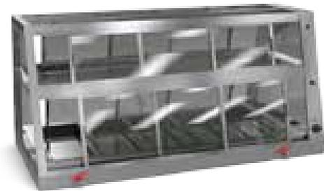
Витрины тепловые настольные двухуровневые для демонстрации и временного хранения блюд. Изготовлены полностью из нержавеющей стали. С пароувлажнением. Подогрев осуществляется ТЭНами, подсветка - лампами накаливания. Двери-купе выполнены из поликарбоната толщиной 4 мм. Регулировка температуры от +40°C до +80°C.
