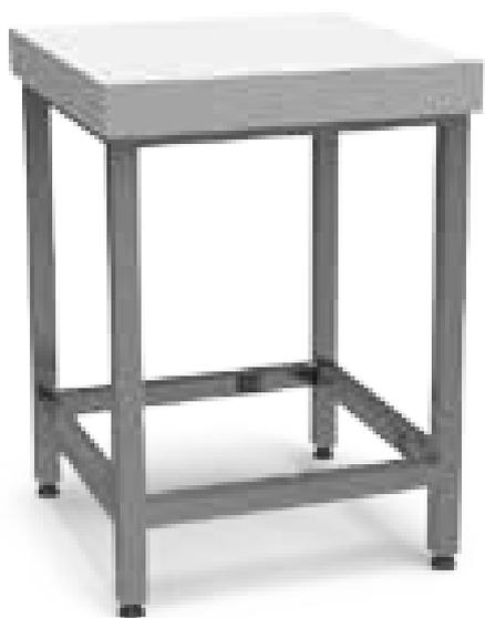
Столы для рубки мяса. Изготовлены полностью из нержавеющей стали. Сварной каркас выполнен из профильной трубы 40\*40, столешница - из полипропилена толщиной 80 мм, опоры ножек регулируются по высоте.
