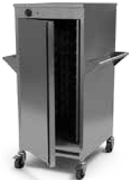
Шкафы тепловые с ручками для временного хранения и транспортировки горячих блюд, расфасованных в гастроёмкости. Изготовлены полностью из нержавеющей стали. Имеют направляющие под гастроёмкости GN1/1, теплоизолированные стенки. Оснащены прорезиненными колесами, два из которых со стопором. Регулировка температуры от +40°C до +85°C.
