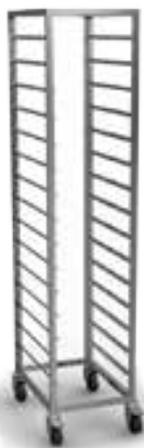
Шпильки для предварительной расстойки, временного хранения хлебобулочных и кондитерских изделий. Имеют прочную конструкцию, направляющие под лотки 400\*600 или 435\*320. Снабжены прорезиненными колесами, два из которых со стопором. Допустимая нагрузка на один уровень - до 7 кг.
