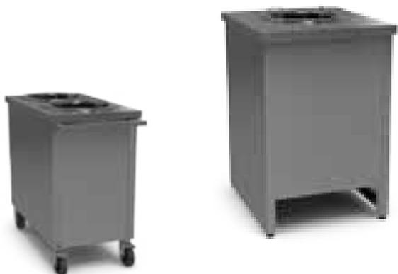
Диспенсеры для нагрева и длительного сохранения в теплом состоянии тарелок диаметром 180-280 мм, используемых для раздачи горячей пищи. Изготовлены полностью из нержавеющей стали. Комплекуются крышками, которые способствуют более быстрому нагреву и поддержанию температуры тарелок. Регулировка температуры от +30°C до +85°C. Возможно изготовление диспенсеров с подогревом и без.
